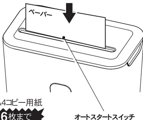
3. ペーパーを中央のオートスタートスイッチを押すようにペーパー挿入口に挿入してください。裁断後、自動的にカッターが停止します。
