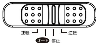
4.終了後は必ずモード切替スイッチを【停止】モードに設定してください。
