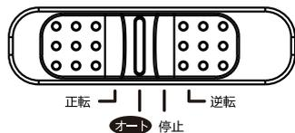
3.ペーパーを中央のオートスタートスイッチを押すようにペーパー挿入口に挿入してください。裁断後、自動的にカッターが停止します。
