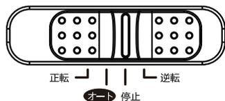
2.モード切替スイッチを【オート】モードに設定してください。ペーパーを中央のオートスタートスイッチを押すようにペーパー挿入口に挿入してください。裁断後、自動的にカッターが停止します。
